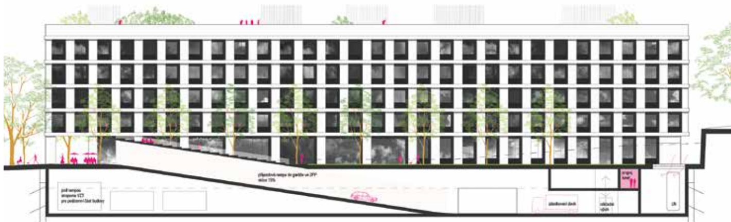
Biocentrum, východní pohled. Fasádu charakterizuje střet vertikálních pilástrů a horizontálních pásů s rytmicky se opakujícími děrovými dvoukřídlymi okny s parapetem. / Biocenter, eastern elevation. The façade features intersections of vertical pilasters and horizontal bands with the rhythmic repetition of two-wing windows with aprons.
